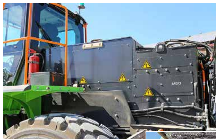
Das Akkupaket des Herstellers Catl ist komplett eingehaust auf dem Heck der Maschine untergebracht.
