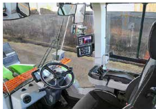
Die Kabine ist gut verarbeitet und bietet ausreichend Platz. Die Bedienung erfolgt optional per „Klaviersteuerung“.
