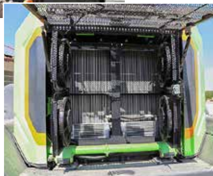
Vier Aggregate kühlen die verschiedenen Hydrauliksysteme.
